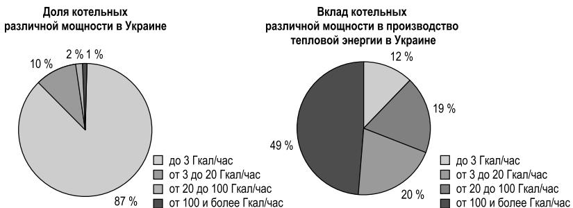
**Рис. 4.** Соотношение доли котельных различной мощности и их вклада в производство тепловой энергии в Украине.
