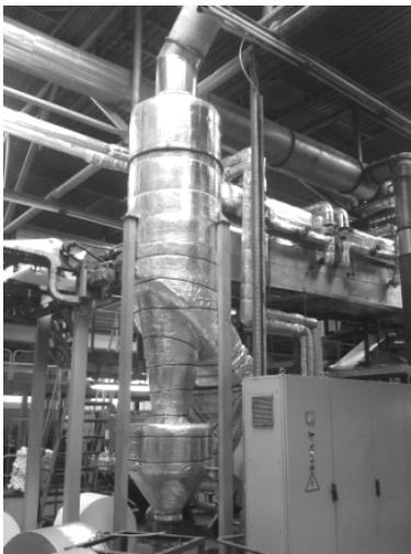
Работа циклонного пылеуловителя основана на принципе двухступенчатой очистки.
