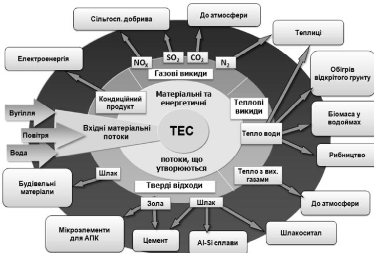
Рис. 1. Схема реалізації методології промислового симбіозу на прикладі твердопаливної ТЕС.
