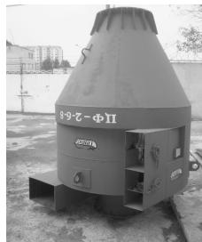
Модули центробежных фильтров могут компоноваться как в блоки заданной производительности, так и в виде многоступенчатых систем очистки.
