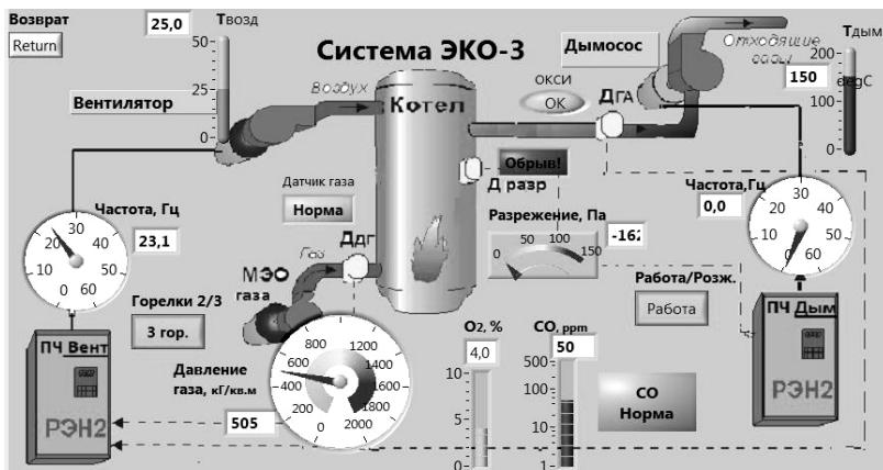
Рис. 1. Режим контроля параметров системы в виде мнемосхемы.
