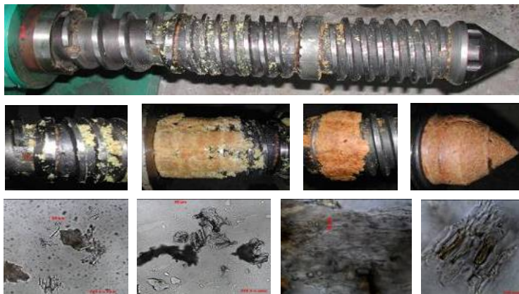
Рис. 2. Динаміка зміни мікроструктури сої під час обробки в екструдері (по функціональним зонам шнека) (при збільшенні 320 св. поле)
