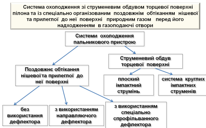
Рис. 1. Запропонована класифікація систем охолодження пристроїв паливників.
