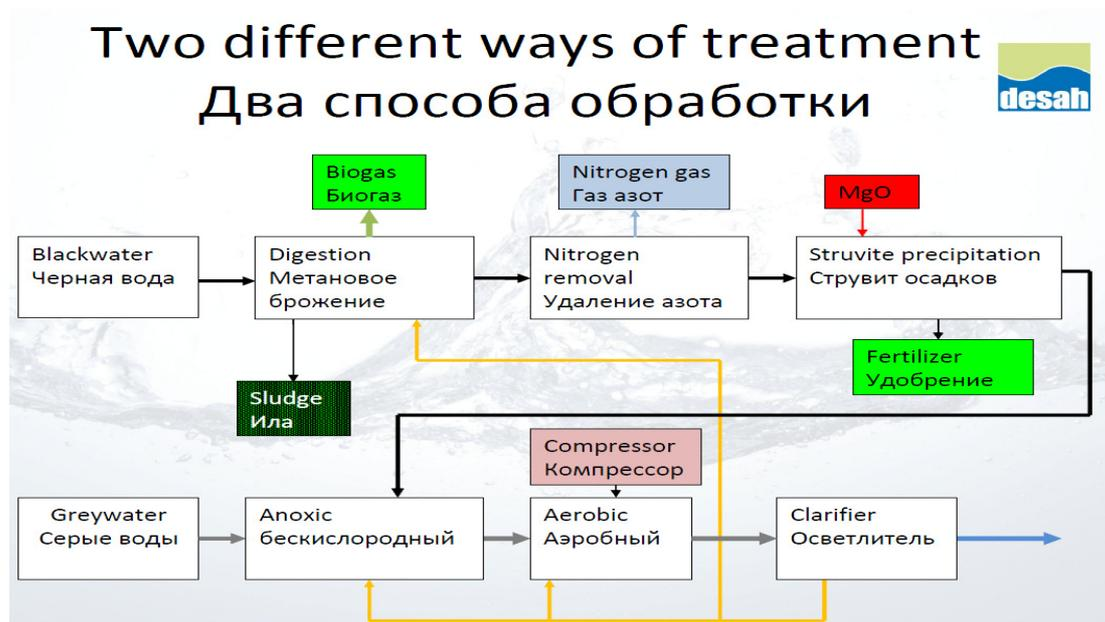
В основе процесса очистки сточных вод лежит принцип распределения воды по ее источникам, то есть существуют два пути водоотвода: «черные» воды – вода из туалетов и кухни, и «серые» воды –
