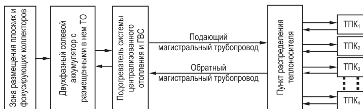
Рис. 2. Структурно-функциональная схема тепловой гелиостанции на основе глубоких карьеров: ТПК 1 ...ТПК n – котельные, преобразованные в тепловые пункты
