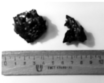
Рис. 2. Агломерати матеріалу шару, отримані при розпалюванні із використанням шлаку АШ у якості інертної складової
