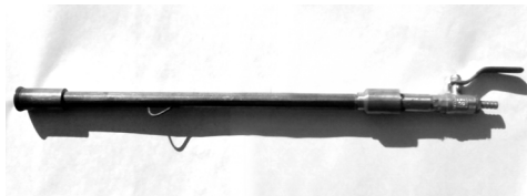
Рисунок. Пальник інжекційний однофакельний середнього тиску для топок із зрідженням на природному газі
